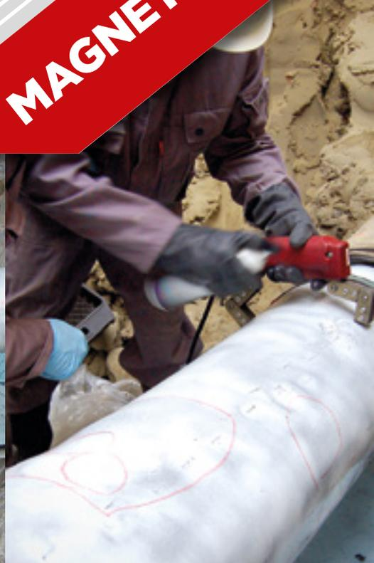
↘ La magnétoscopie (*Magnetic particle testing* en anglais) est, comme le ressuage, une des méthodes incontournables d'END et aussi une des plus anciennes. Elle est utilisée pour détecter des discontinuités de surface, débouchant en surface ou sous-jacentes (dans certaines conditions, jusqu'à quelques millimètres de profondeur), exclusivement sur matériaux ferromagnétiques.
